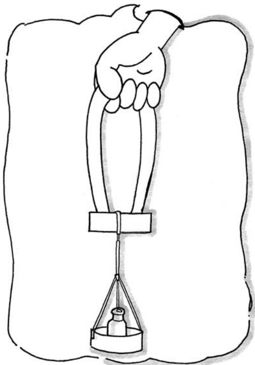
**B)** Ripeti l'esperienza utilizzando delle altre calamite a ferro di cavallo, di varie dimensioni e prova a confrontare la misura della forza magnetica esercitata dai diversi magneti.
